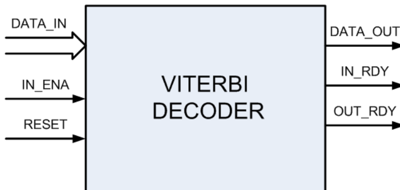
Obrázek 12: Znázornění vstupů a výstupu Viterbi dekodéru
